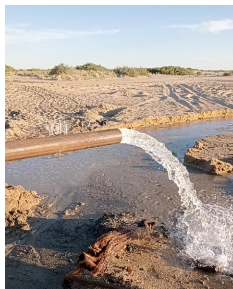
Рис. 3. Скважина 10р. Расход скважины на самоизливе 12 л/с.
