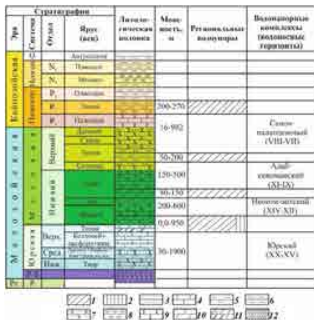
Рис. 2. Схема строения мезозойской водонапорной системы Чарджоуской ступени (по материалам Т.Х.Шоймуротова, 2018 г.). Водоупоры: 1 – региональные, 2 – локальные; 3 – пески; 4 – известняки; 5 – глины; 6 – алевролиты; 7 – песчаники; 8 – конгломераты; 9 – доломиты; 10 – мергели; 11 – гипсы, ангидриты и соли; 12 – породы эффузивного происхождения.
